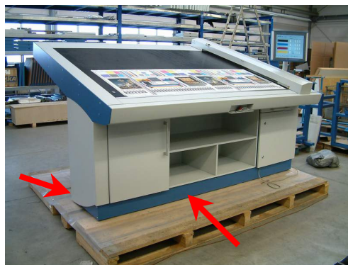
Blenden im Fußbereich vorn und hinten abschrauben (Inbus-Schrauben M5)
