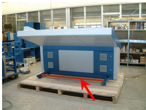
Transporthilfe zwischen den Füßen hinten auf Festigkeit kontrollieren, gegebenenfalls montieren / festziehen (Tischgrößen 162, 205; roter Bügel)
