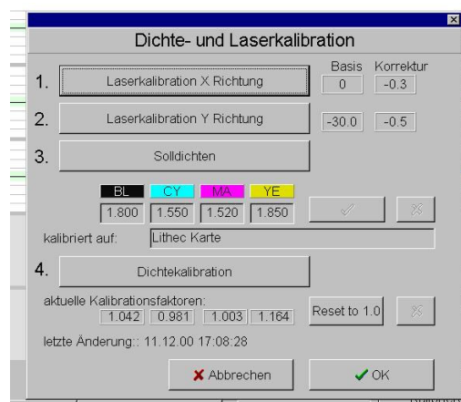
Рис.: Калибровка плотности и лазера
