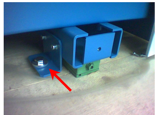
Transportsicherungs-Schrauben M10 aus der Palette herausschrauben (4x)
